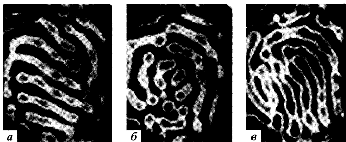
Фиг. 4. Эволюция конвективной структуры при \Delta T/\Delta T_C \sim 4 ; время между кадрами (а–в) – 20 мин; вид сверху; разность температур между темной и светлой областями около 3 К
