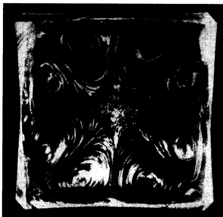
Фиг. 2. Осредненное движение водоглицериновой смеси; Re_p = 4,1 , \omega = 1100
