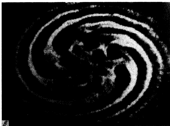
Фиг. 5. Теневая фотография формы свободной поверхности жидкости, показывающая эволюцию конфигурации спиральной волны по мере приближения источника тепла к свободной поверхности жидкости
