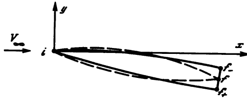
Фиг. 1. Контуры профилей с задним торцом и с остrokонечной задней кромкой
