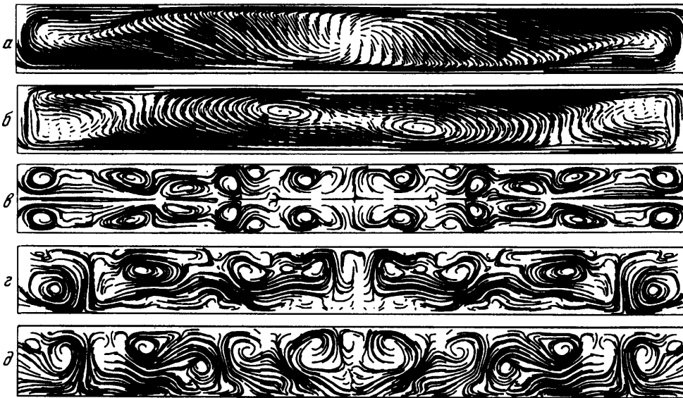
Фиг. 7. Течение в полости с разнонаправленно движущимися крышками, H/L = 0,1 , Re = 5000 : а - Y = 1/2 , б - Y = 1/16 , в - X = 1/2 , г - X = 7/8 , д - X = 15/16
