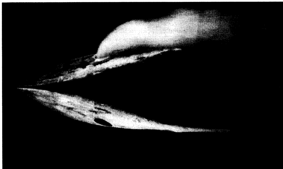
Фиг. 3. Фотография струи, вытекающей из канала, имеющего форму круга, при m = 0,5 . Экспозиция 1/60 с
