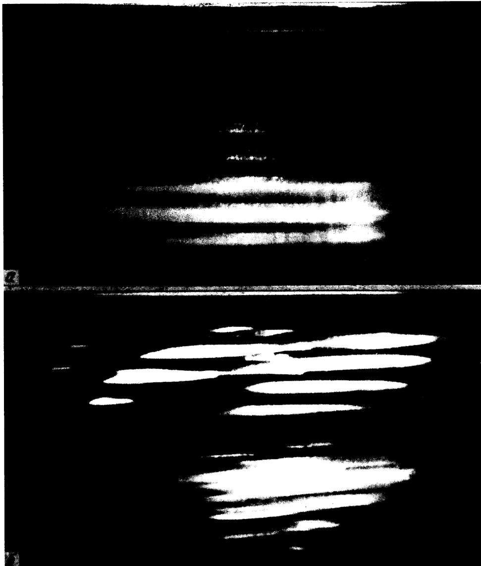
Фиг. 2. Примеры течения в спиралеобразном режиме (а) и в режиме регулярных вихревых структур (б). Визуализация в верхней части картины – каллироскопической пудрой, в нижней части – чернилами
