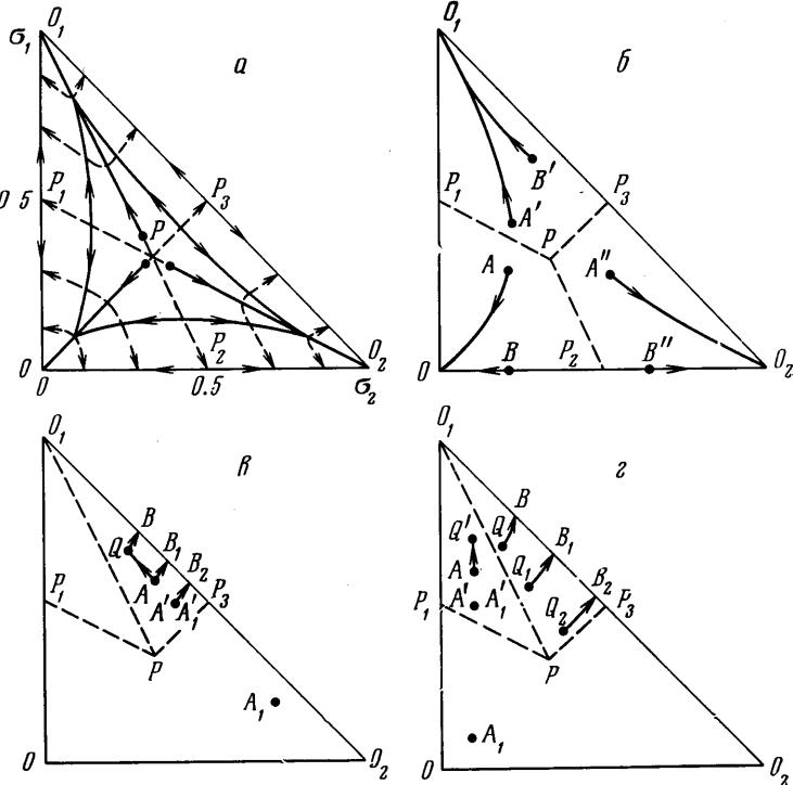
ление убывания  $\xi$  вдоль характеристик. Особыми являются точки  $P, O_1, O_2$ , в которых  $H(\sigma_1, \sigma_2) = 0$ . В них соприкасаются поверхности  $\xi^+$  и  $\xi^-$ . Через  $P$  проходят сепаратрисы  $PO, PO_1, PO_2$  для  $s^+$  и  $PP_1, PP_2, PP_3$  для  $s^-$ . Вдоль  $s^+$  и  $s^-$  соответственно  $\xi^+$  и  $\xi^-$  монотонно убывают от максимального значения на сепаратрисе противоположного семейства до нуля на границе области.
