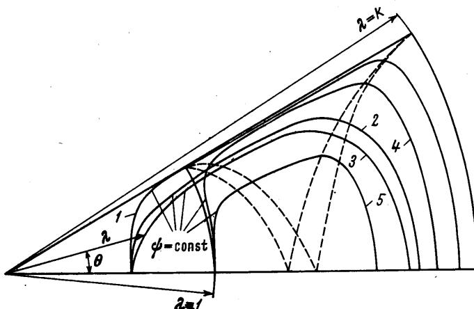
Интересен характер кривых 4 и 5, начинающихся на звуковой линии  $\lambda = 1$ . Следует также отметить, что ни одна линия тока из дозвуковой области течения не заканчивается на звуковой линии.
