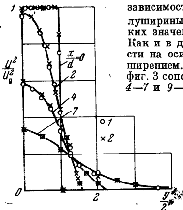
Фиг. 5. Профили скорости в поперечных сечениях струи: 1 — кривая 10; 2 — кривая 11 (см. таблицу)
