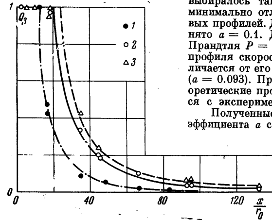
Фиг. 6 Изменение скоростного напора по оси струи. Экспериментальные точки: 1 ( \rho_2/\rho_0 = 1 , T_2 = 280^\circ \text{K} ); 2 (0.061, 280^\circ ); 3 (0.039, 400^\circ ). Теоретические кривые: 1 ( \rho_2/\rho_0 = 0.061 , a = 0.072 ); 2 (0.039, 0.072); 3 (1, 0.083)
