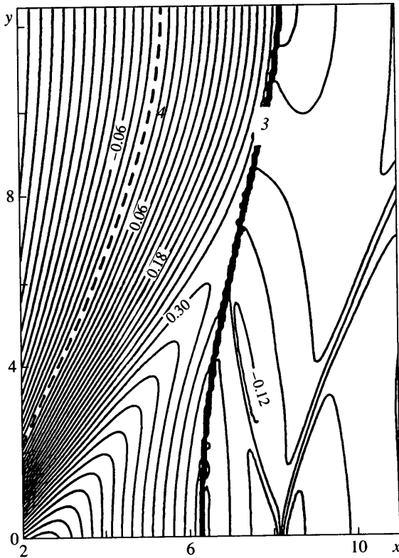
Фиг. 3. Фаза течения с одной ударной волной, перекрывающей канал ( t = 48 ): 3 – ударная волна, 4 – звуковая линия
