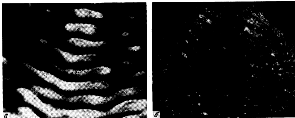
Фиг. 3. Общий вид свободной поверхности расплава галлия в вибрационном поле: а – стационарный режим со стоячими поверхностными волнами (малая амплитуда вибрации), б – ячеистая конвекция в расплаве (высокий уровень амплитуды вибрации). Характерный размер турбулентных конвективных ячеек составляет 3 мм
